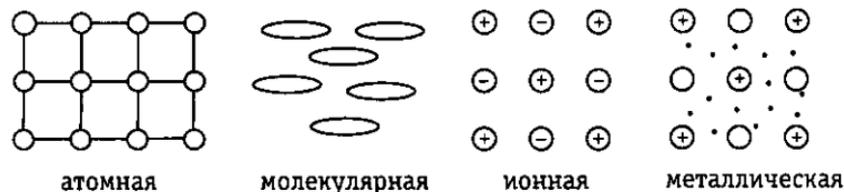
Рис. 21. Основные структуры твердого вещества (схема).
