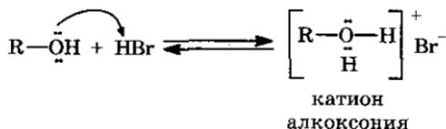
Если кислота — галогеноводородная, то отрыв молекулы от иона алкоксония приводит к образованию галогеноводорода:
